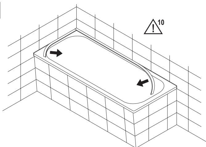
⚠ 10 Nach den Fliesenarbeiten das Schalldämmband vollständig entfernen.
