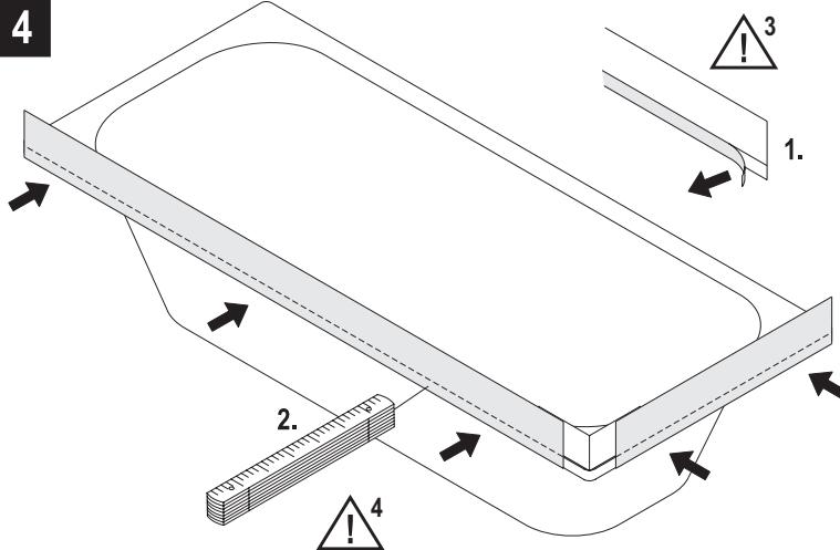
! 3 Vor Aufkleben des Wannenranddichtbandes die Schutzfolie gleichmäßig abziehen.
