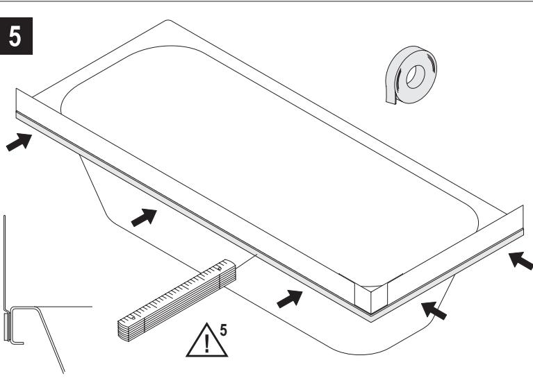
! 5 Schalldämmband mit Zollstock faltenfrei anpressen.
