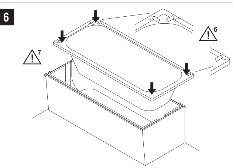
! 6 Vor Einsetzen der Badewanne das Wannenranddichtband mit Klebebandstreifen auf dem Wannenrand fixieren.
