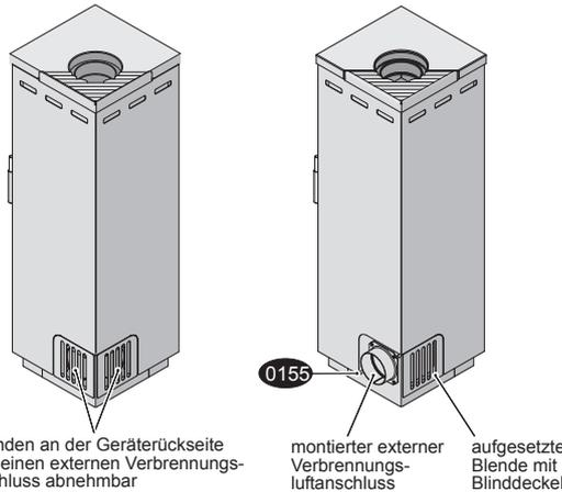
Die Blenden an der Geräterückseite sind für einen externen Verbrennungsluftabschluss abnehmbar
