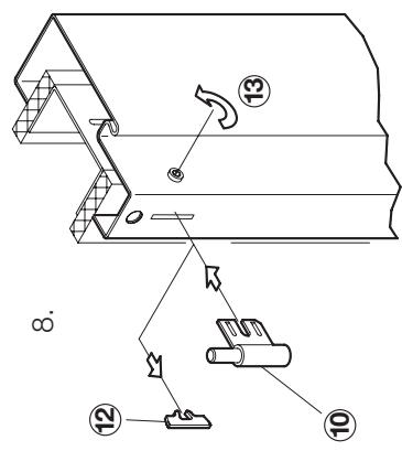
Entsprechend der gewünschten Anschlagart, die Klemmplatte in der Bandtasche mit einem Inbusschlüssel 5 mm lösen. Transport Sicherung der Bandtasche (12) mit einem Schraubendreher entfernen, Rahmen teil (10) mit leichten Schlägen in die Öffnung eintreiben. Mit der Inbusschraube (13) in der Bandtasche das Rahmen teil (10) festsetzen.
