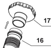
Schließen Sie das andere Ende des Skimmerschlauches (16) an den Schlauchanschluss B (17) an.
