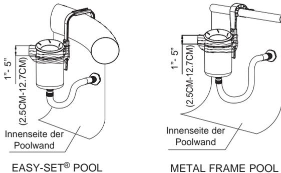
**WICHTIG:** Der Skimmer muss immer senkrecht zur Wasseroberfläche sein, sodass die schwimmende Abdeckung parallel zur Wasseroberfläche liegt.
