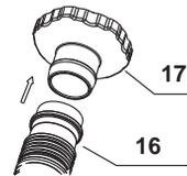
Schließen Sie das andere Ende des Skimmerschlauches (16) an den Schlauchadapter B (17) an.
