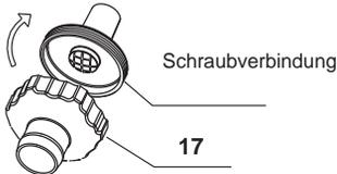
Schrauben Sie den Schlauchadapter B (17) von der Innenseite des Pools an die Schraubverbindung.
