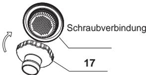
Schrauben Sie den Schlauchanschluss B (17) von der Innenseite des Pools an die Schraubverbindung.
