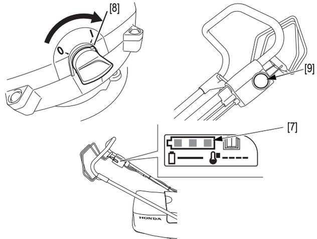
4. Die verbleibende Akkukapazität wird in 3 Stufen angezeigt.
