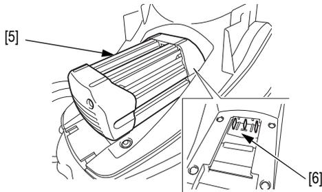
4. Verschließen Sie die Akkuabdeckung sicher.
