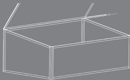
4) Die Eckverbinder des Deckels sowie des Frühbeet-Rahmens sind durch einfaches Aufstecken zu befestigen.
