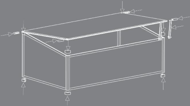
5) Die Bodenanker werden durch die Bohrung des Eckverbinders in allen vier Ecken gesetzt.
