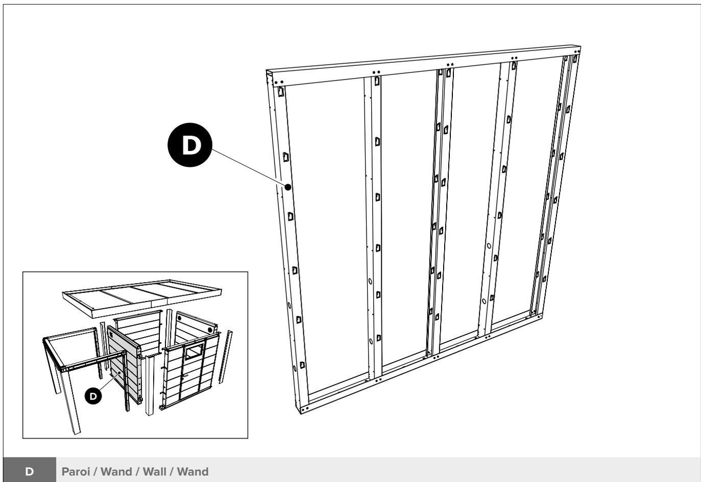
Le principe de la construction du mur, voir pages 8 à 11 (POW).
