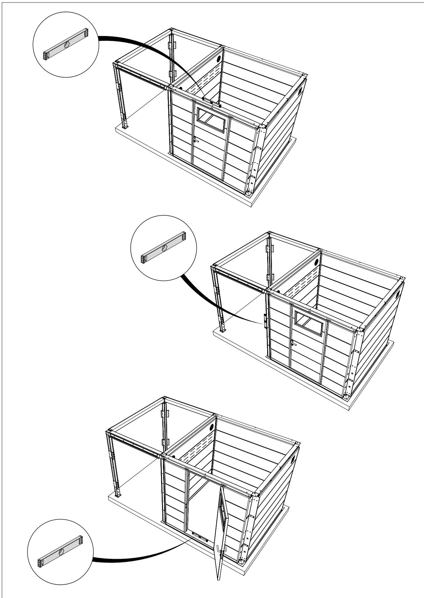
Retirer la bande / Tape verwijderen / Remove tape / Klebeband entfernen
