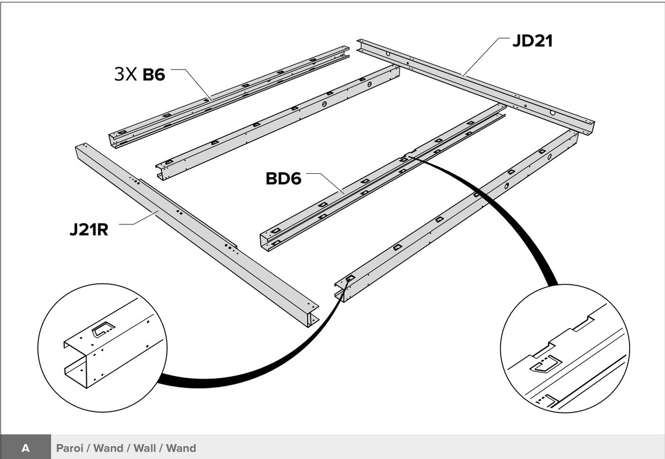
Le principe de la construction du mur (POW).
