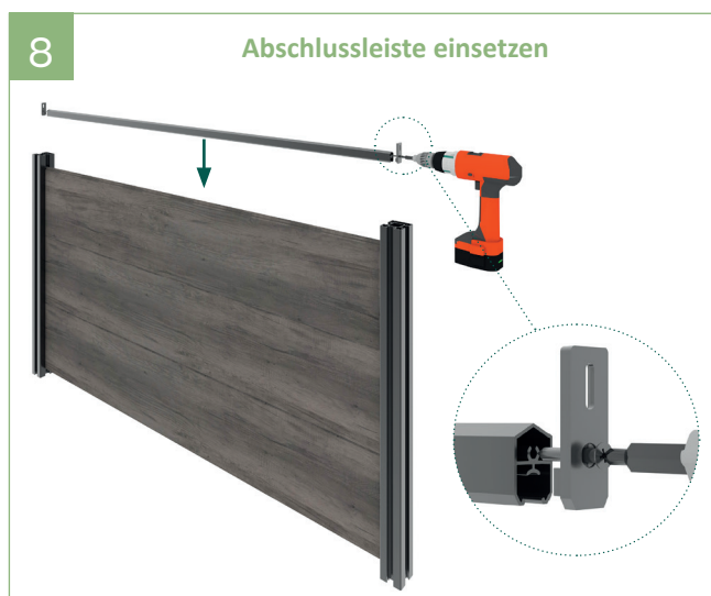
8 | Die Halterungen an der Abschlussleiste mit den 3,9 x 25 mm Bleischrauben (im Lieferumfang enthalten) verschrauben. Die Abschlussleiste inkl. Halterung von oben in die Pfostennut schieben.
