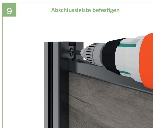
9 | Die Halterungen mit den 3,9 x 25 mm Bohrschrauben (im Lieferumfang enthalten) am Pfosten mittig vom Langloch befestigen
