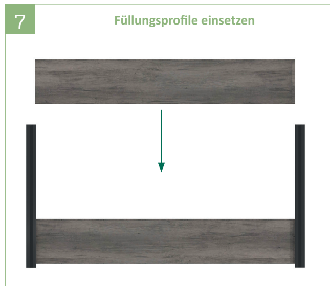
7 | Die drei Füllungsprofile inkl. der Stahlverstärkung des BasicLine Vorgartenzauns von oben in die Pfostennuten einschieben. Bitte die Anordnung unter Punkt 8 berücksichtigen.
