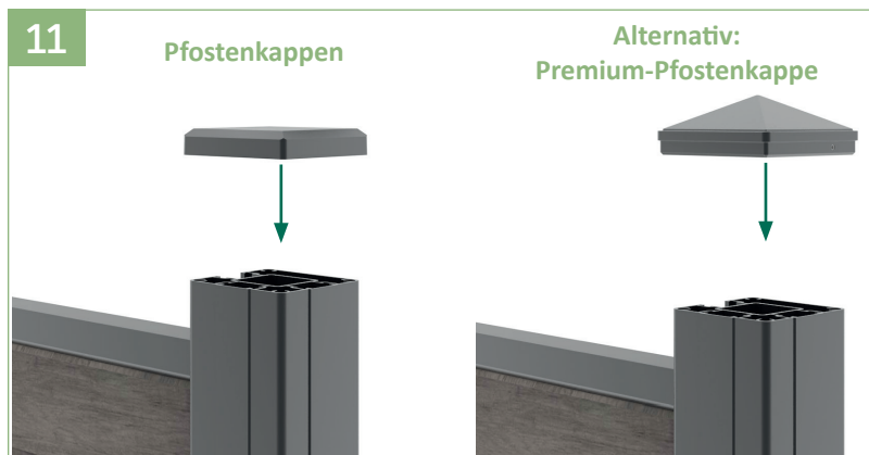
11 | Zum Schluss die Kappen auf die Pfosten setzen. Bei Einsatz der Premium Pfostenkappe die Kappe auf den Pfosten aufstecken und mit den beiden Gewindestiften (bereits in der Kappe vormontiert) mit dem Innensechskantschlüssel (im Lieferumfang enthalten) fixieren.
