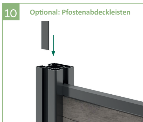
10 | Die Pfostenabdeckleisten von oben in die Pfostennuten einschieben und mit der Unterkante des Pfostens bündig abschließen.
