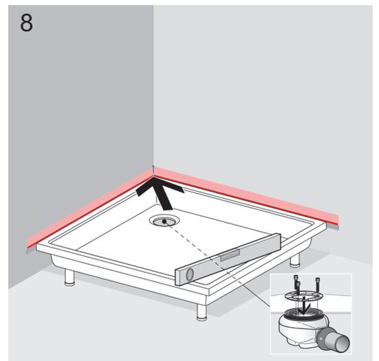
8. Ablaufgarnitur montieren, Dusche/Wanne an der Einbaustelle positionieren.
