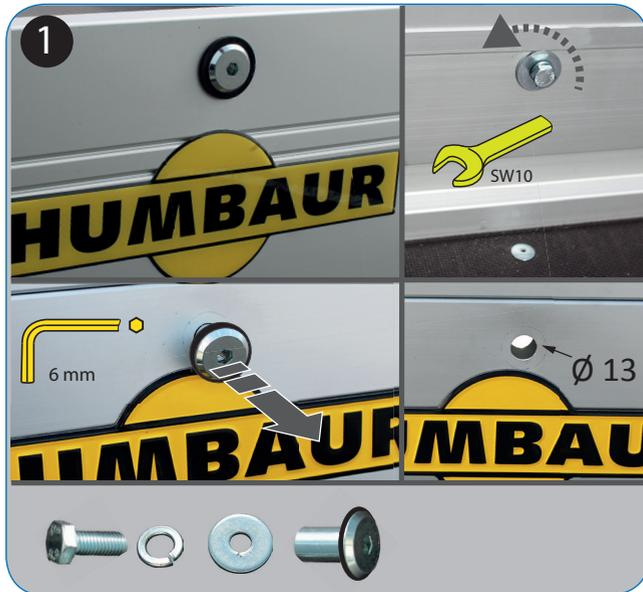
▶ Vorhandene stirnseitige Schraubbefestigung lösen.
