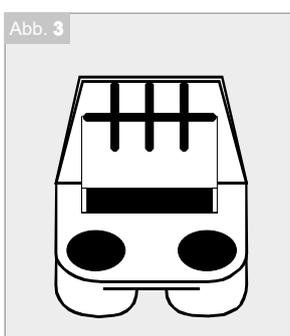
Mit der beiliegenden Bohrerschablone (Abb. 3) werden die notwendigen Bohrungen für die Bandunterteile eingebracht. Die Schablone am Aufrechtteil anlegen und an der Klemmnussfräsung fixieren. Mit einem  $\varnothing 7,0$  mm Bohrer die Bohrungen ca. 42 mm tief einbringen.
