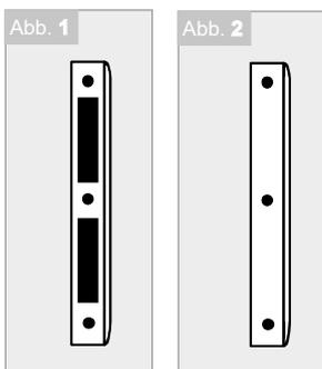
An den Aufrechtteilen ist das Schließblech (Abb. 1) bereits für beide DIN Richtungen ausgefräst. Entsprechend der gewünschten Drehrichtung wird das Schließblech in einem Aufrechtteil, das geschlossene Schließblech (Abb. 2) inkl. Kunststoffunterteil in dem anderen Aufrechtteil montiert.
