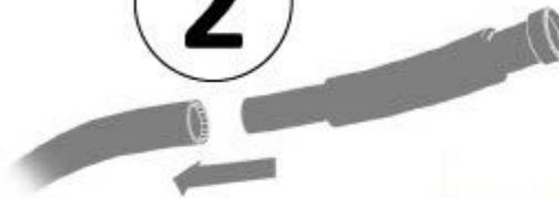
Verbinden Sie den flexiblen Schlauch mit der Abflussleitung.
