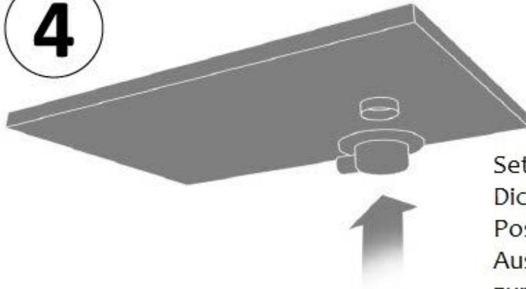
Setzen Sie den Abfluss und die Dichtung mit Sanitärkitt ein. Positionieren Sie dabei den Auslass in der richtigen Richtung zum Abfluss.
