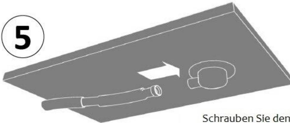
Schrauben Sie den flexiblen Schlauch an den Abfluss.
