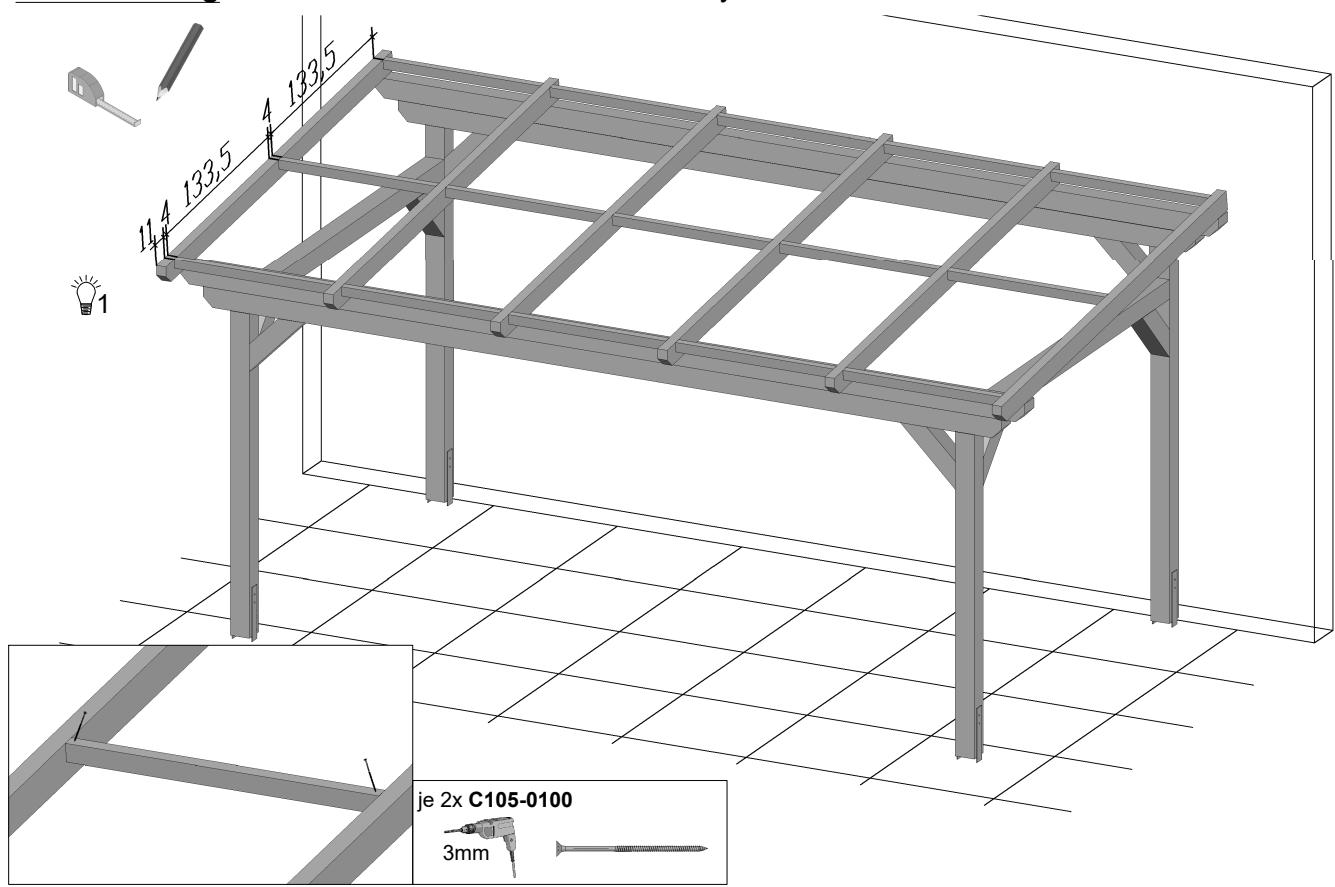
**10. Dacheindeckung** / Roofing / Toiture / Dakbedekking / Zastrešení / Strešné krytiny
