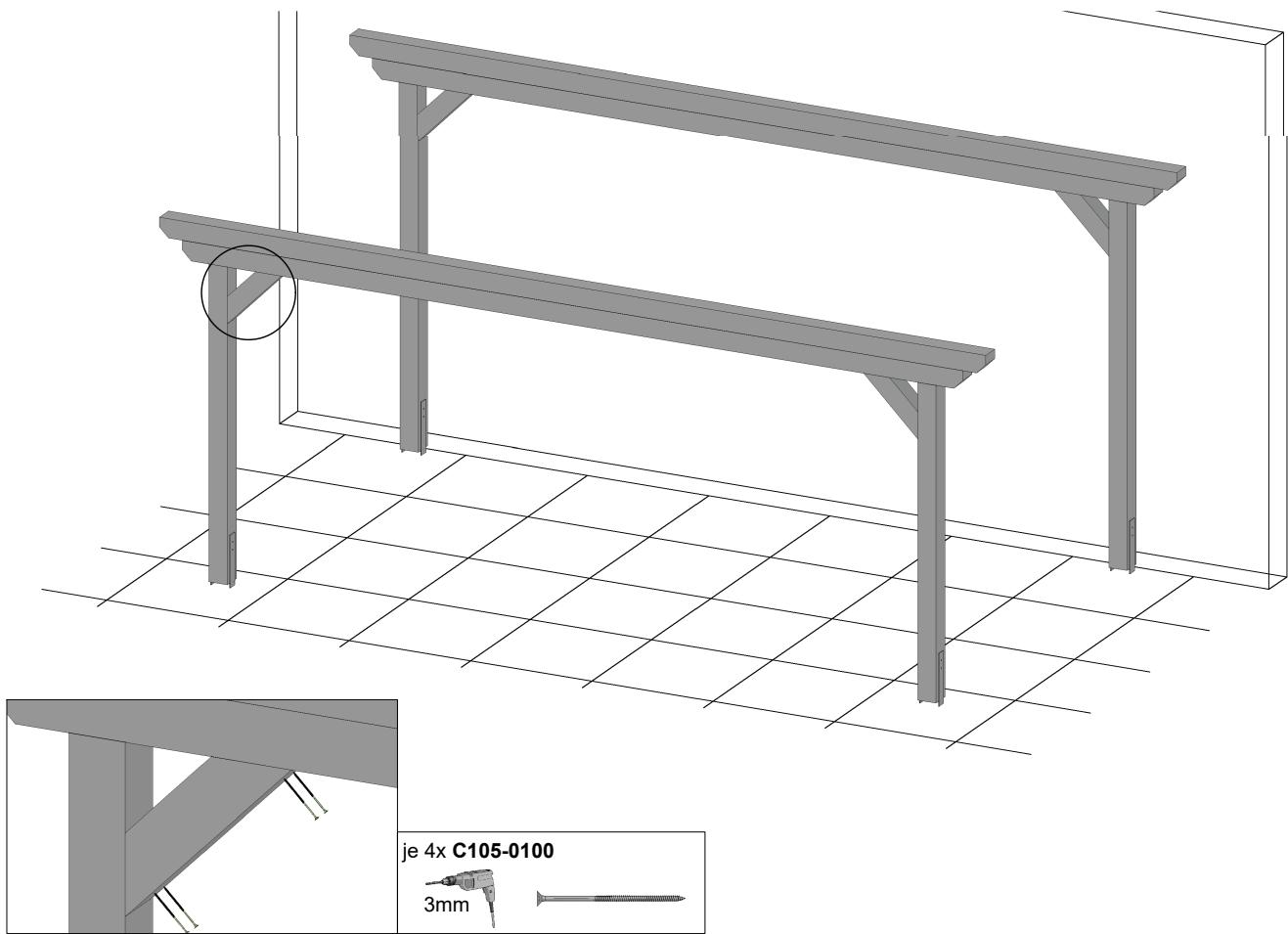
**6. Riegel LH12/12 / Beam / Poutre / Balk / Paprsek / Lúč**
