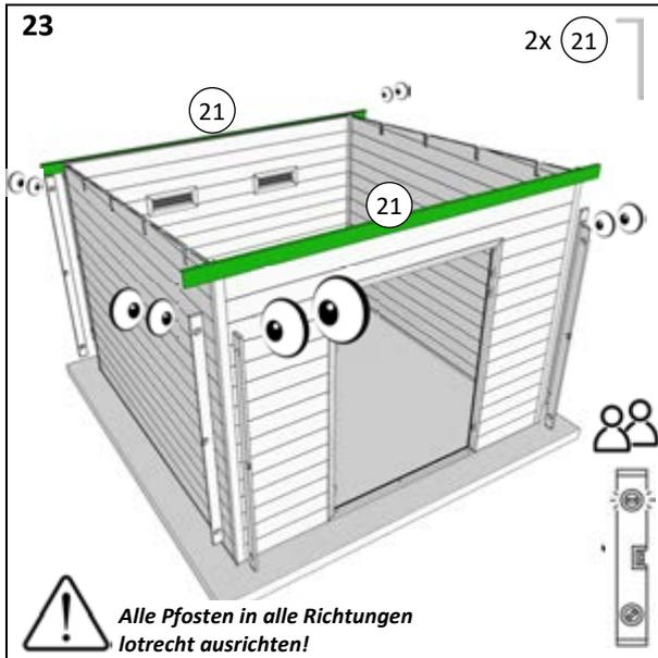
**! Alle Pfosten in alle Richtungen lotrecht ausrichten!**
