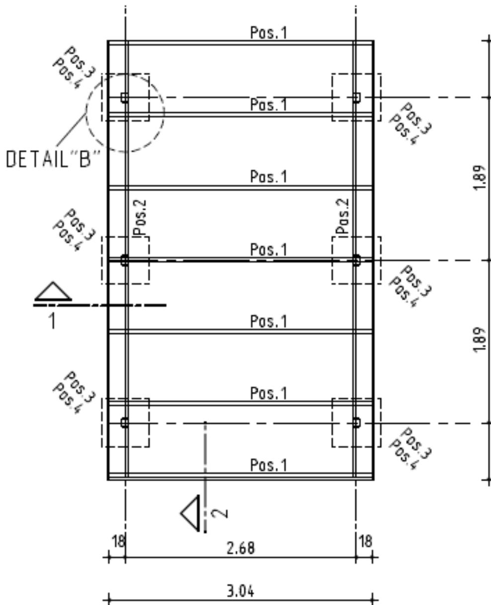
Legen Sie die Sparren auf die Tragbalken und befestigen Sie diese wechselseitig mit den HVV Winkeln, die Sie wiederum mit Spax-Schrauben 4x30 mm befestigen (siehe Skizze Nr. 2).
