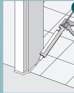
**25** Wenn die Zarge auf einem Hartboden steht: Versiegeln Sie vor der ersten Bodenreinigung die Zarge unten am Bodenbelag umlaufend mit einer dauerelastischen Dichtmasse (z. B. Silikon).
