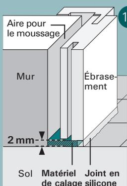
12 Pour les sols durs (carrelage, parquet, etc.), veuillez placer une cale de 2 mm d'épaisseur sous l'ébrasement.
