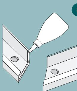
8 Posez le contre chambranle (C et D) sur une surface plane et propre.
