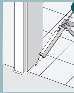
25 Si l'ébrasement repose sur un sol dur: scellez-le tout autour dans sa partie inférieure au niveau du revêtement de sol avec un mastic d'étanchéité à élasticité permanente (par ex. du silicone) avant de nettoyer le sol pour la première fois.
