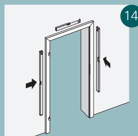
14 Utilisez un niveau à bulle du côté de la fiche et de la gâche pour vérifier que toutes les parties de l'ébrasement sont d'aplomb et au même niveau dans tous les sens et qu'elles ne sont ni gondolées ni gauches.
