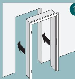
11 Avant de poser l'ébrasement : vérifiez que l'ébrasement et l'ouverture du mur sont exempts de poussière et de graisse afin que la mousse PU puisse parfaitement y adhérer.
