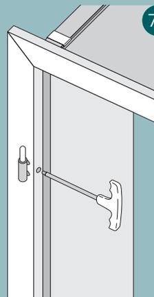
7b Ensuite, tournez la vis à la main jusqu'à la butée et serrez-la fermement. (7b)
