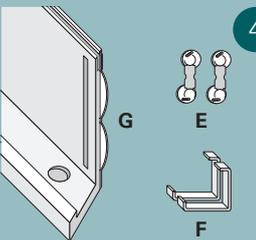
4 Insérez les lamellos (G) dans la rainure de l'onglet et poussez le ressort vers l'extérieur aussi loin que possible.
