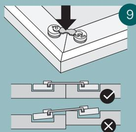
9 Assemblez les deux parties. Insérez les excentriques (E) dans l'ouverture et serrez-les légèrement.
