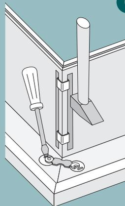
6 Serrez ensuite fermement les excentriques (E) à l'aide d'un tournevis plat.
