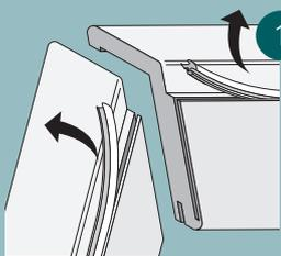
1 Retirez le joint de l'ébrasement d'environ 30 cm de la partie verticale et transversale.
