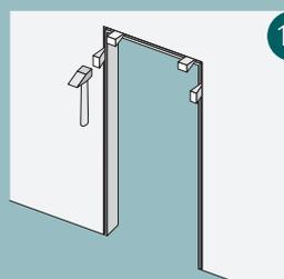
13 Maintenez l'ébrasement avec des cales ou des coins, horizontalement et verticalement, dans l'ouverture du mur.
