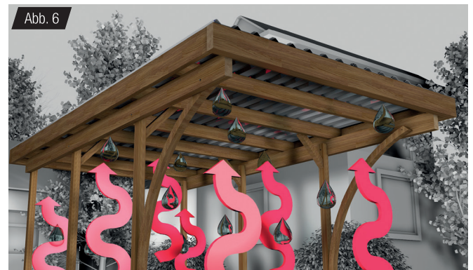
Feuchtigkeit steigt nach oben und bildet Kondenswasser, das ohne richtige Lüftung von dem Dach abtropfen kann. Deshalb muss für ausreichend Luftstrom gesorgt werden.
