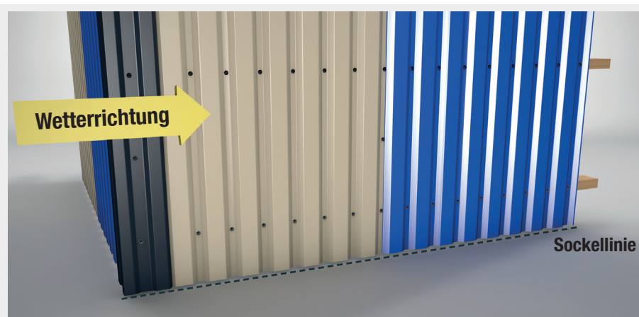
Die Platten müssen winklig an der Sockellinie ausgerichtet werden. Bei einer leicht schrägen Wand müssen ggf. überstehende Teile abgeschnitten werden.
