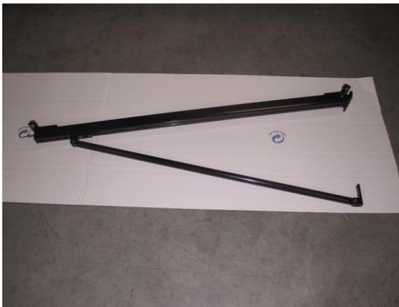
**Abbildung 2 (Stützarm vormontiert)**
