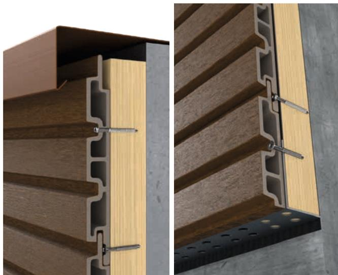
Pour la pose horizontale, démarrer l'assemblage des lames par le haut et orienter les lames avec la languette positionnée vers le haut.
