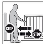
1. Um den Sicherheitsrücklauf zu prüfen, halten Sie das Tor während es zufährt mit beiden Händen an. Die Toranlage muss anhalten und den Sicherheitsrücklauf einleiten.
