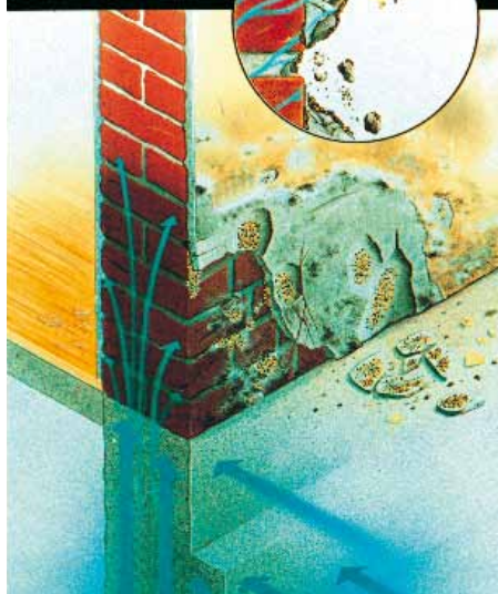
Feuchtigkeit im Mauerwerk mit herkömmlichem Putz. Salze „sprengen“ den Putz.
