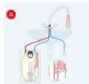
C'est uniquement lorsque de l'eau continue de s'écouler du robinet quand le chauffe-eau est éteint et que la soupape est fermée que le robinet est défectueux.
