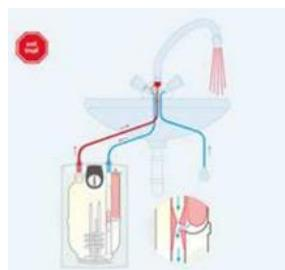
O závade batérie sa jedná len vtedy, pokiaľ voda z batérie kvapká neustále aj pri vypnutí zásobníka na teplú vodu a pri zatvorenom ventile
