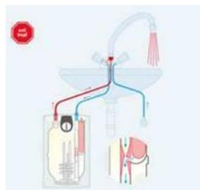
De kraan is alleen defect als er water uit de kraan blijft druppelen wanneer de warmwaterboiler is uitgeschakeld en de kraan is gesloten.
