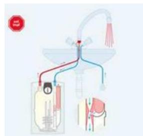
Blandaren är endast defekt om det droppar vatten ur blandaren när varmvattenberedaren är avstängd och ventilen är stängd.
