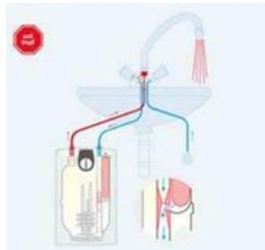
Nur wenn bei ausgeschaltetem Boiler und geschlossenem Ventil nach wie vor Wasser aus der Armatur tropft, liegt ein Defekt der Armatur vor.
