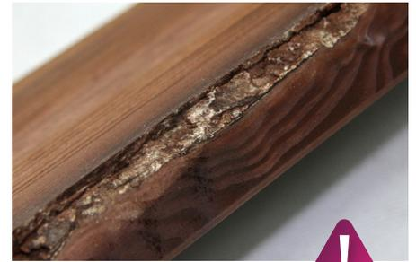
Kantenausbruchäste – kleine auf der Rückseite erlaubt
