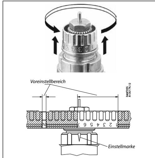
Bei voreinstellbaren Danfoss Ventilgehäusen lassen sich die dimensionierten Einstellwerte ohne Werkzeug einfach und exakt einstellen:
