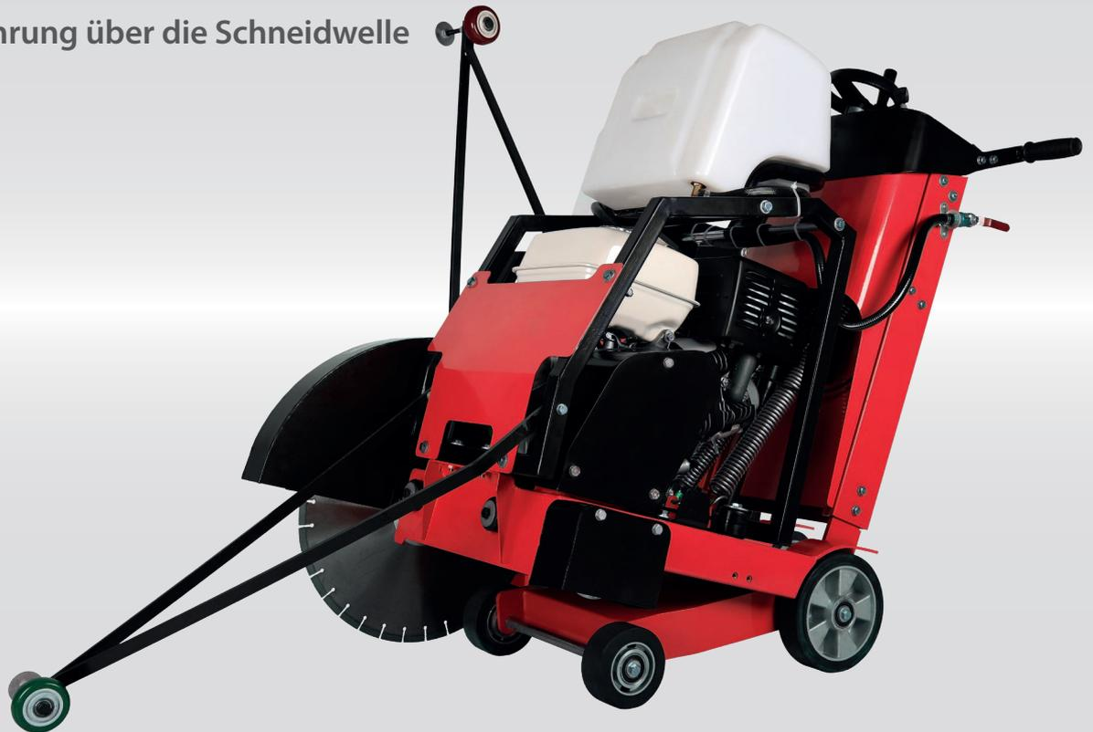
Universal-Fugenschneider für Asphalt- und Betonoberflächen mit leistungsstarkem Motor. Bestens geeignet für Straßenarbeiten, Kabelverlegungen, etc. Stufenlose Schnitthöhenverstellung von 0-190 mm. Nass- und Trockenschnitt möglich. Wasserzufuhr durch den eingebauten Wassertank (25 l) bzw. Direktanschluss.
