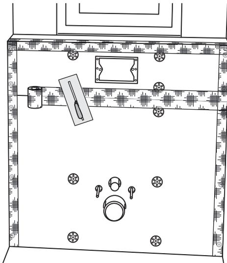
5) Maroufler une bande d'armature (p.ex. bande d'armature JACKOBOARD®) avec de la colle à carrelage sur tous les joints et bords.
