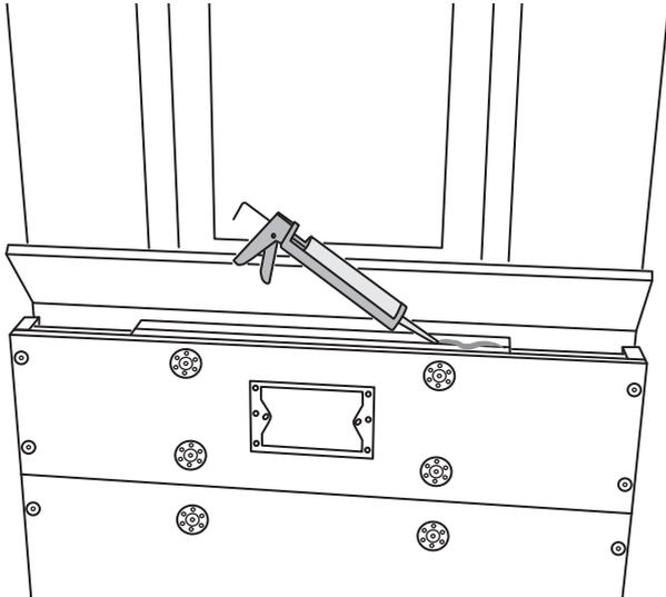
4) Après découpe, visser le panneau de recouvrement. Il peut également être collé avec une colle de montage (p.ex. colle de montage JACKODUR®, BOARD-FIX®).
