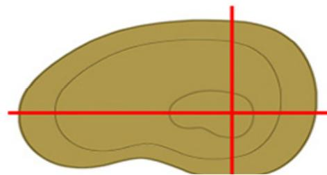
zur Ermittlung der Foliengröße, ein Maßband längs und quer durch die Grube legen und umlaufend 30 cm Randzugabe berücksichtigen
