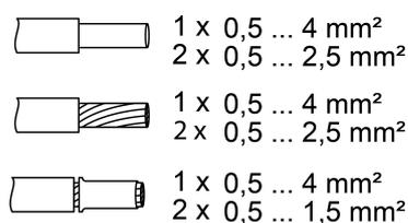
Bild 2: Klemmbare Leiterquerschnitte
