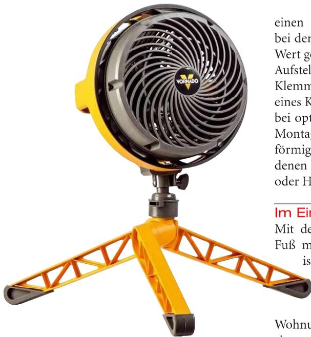
Das Gehäuse des EXO 5 besteht aus relativ weichem Kunststoff. Es lässt sich zur Reinigung zerlegen. Das für eine bessere Verwirbelung ausschlaggebende Bauteil befindet sich auf der Rückseite des Geräts. Ein konisch zulaufender Ring sorgt für einen zweigeteilten Luftstrom. An der Vorderseite entstehen so ein innerer und ein äußerer Luftstrom, die sich umeinander drehen. Mit über 20 m Reichweite sorgt dieser Luftwirbel auch in größeren Räumen für gute Durchlüftung. Da es sich beim EXO5 um
