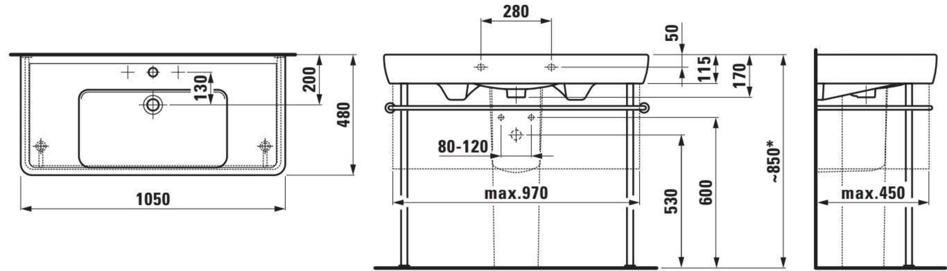
\* = Die effektive Höhe muss entsprechend der Höhe des Sockels fixiert werden.
