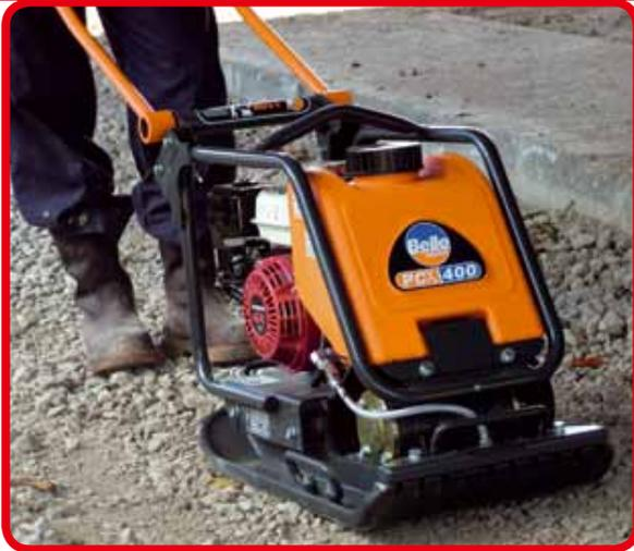
**Kombinierte vorlaufende Rüttelplatten für Erd- und Asphaltarbeiten**
