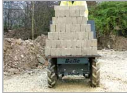
**FLACHBETT** für Betonblöcke und Zementsäcke
