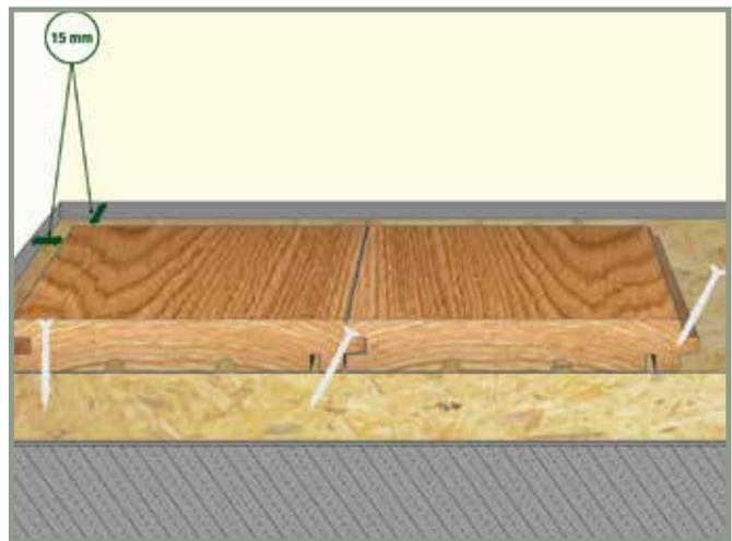
**2. Unterkonstruktion 1:** Verlegung auf schraubfesten Platten, z.B. OSB-Platten. Einhalten der Wandabstände von min. 15 mm. Die erste Dielenreihe mit der Nut zur Wand in der Flucht ausrichten und von oben auf die Platte verschrauben.
