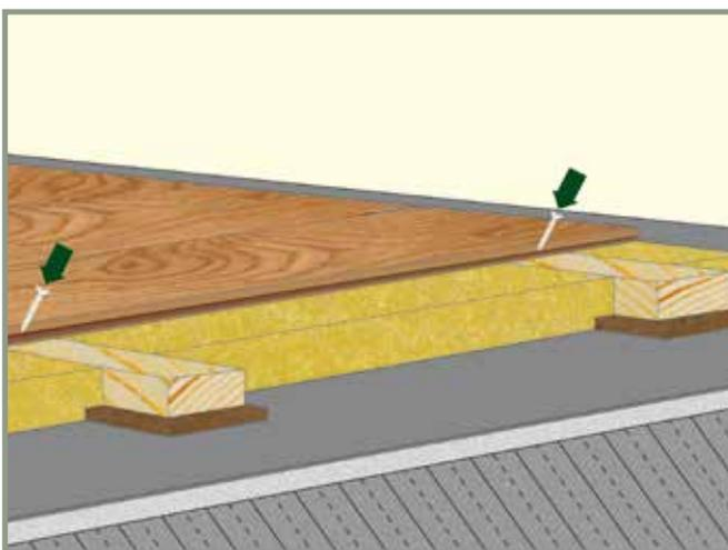
**5. Unterkonstruktion/Verschrauben:** Den Hohlraum zwischen den Lagerhölzern mit Schüttung oder Isolierung (z.B. Zellulose) ausfüllen. Die Dielen mit speziellen Dielenschrauben durch die Feder auf die Lagerhölzer verschrauben.
