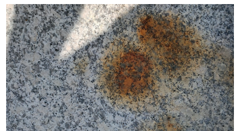
Tâches de rouille dues à des corps étrangers (illu. 2)
