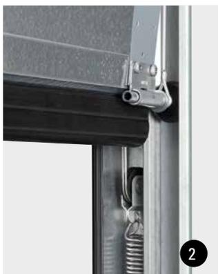
Doppelte Zugfedern in der Seitenzarge gewährleisten eine hohe Sicherheit beim Bedienen des Tores. Dabei schützt das patentierte 2-fach-Feder-in-Feder-System bei einem Federbruch vor Verletzungen durch umherfliegende Teile. Das Sicherheitsseil sorgt für zusätzlichen Halt bei einem möglichen Federbruch.
