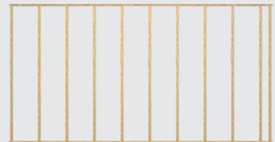
Achsabstand Unterkonstruktion max. 500 mm
