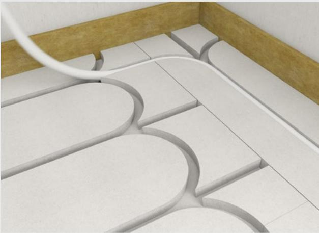
Einbringen der 16 mm Heizrohre, die spezielle Fräsung erfordert keine zusätzliche Befestigung der Heizrohre. Durch individuelle Zuschnitte der Therm25™ Elemente können verschiedenste Rohrführungs-Situationen auch ohne die Therm25™ rund Elemente realisiert werden
