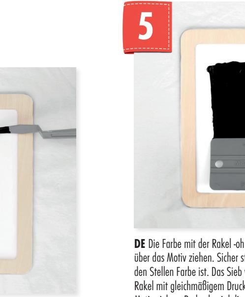
**DE** Sieb auf dem zu bedruckenden Textil positionieren. Die flache Seite des Siebes liegt auf dem Textil auf, damit liegt die Papierschablone direkt auf dem Stoff. Falls Schriften verwendet werden, sollten diese jetzt durch das Sieb lesbar und nicht spiegelverkehrt sein. Farbe in einer Linie, die ca. 1 cm breit ist, auf den oberen Siebrand geben.
