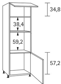
Hochschrank für Mikrowelle und Backofen, 1 Klappe, 1 Drehtür
