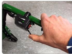
Daumenhebel für eine stufenlose Einstellung der Geschwindigkeit
