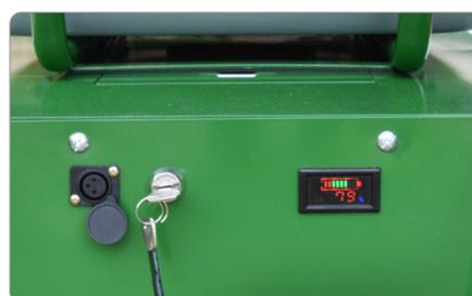
Übersichtliche Bedienarmatur mit Schlüssel, Ladebuchse und LED-Display mit Ladestandsanzeige
