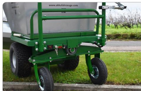
Durch die Pendelachse werden Unebenheiten ausgeglichen. Die Antriebsräder haben immer Traktion auf dem Untergrund
