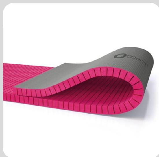
Mit der formbaren Bauplatte **Qboard® qreative** erstellen Sie jede gewünschte Rundung. Sie ist bereits werkseitig eingeschlitzt und ist besonders gut geeignet für Sitzmöbel oder wellenförmige Trennwände. Direkt verfliesbar, verspachtel- und verputzbar.
