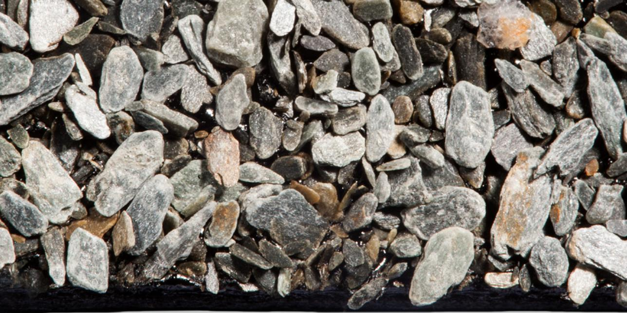
*Abb. Makroaufnahme einer beschieferten Bitumenbahn.*
