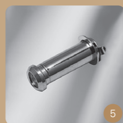
5 Judas: peut être commandé pour un perçage de 12 mm de Ø ; le trou du judas est réalisé en usine. Le judas est livré en vrac pour le montage. Alternative: commande d'un trou de judas et utilisation par le client d'un judas disponible dans le commerce.
