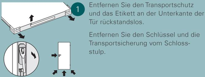
1 Entfernen Sie den Transportschutz und das Etikett an der Unterkante der Tür rückstandslos.
