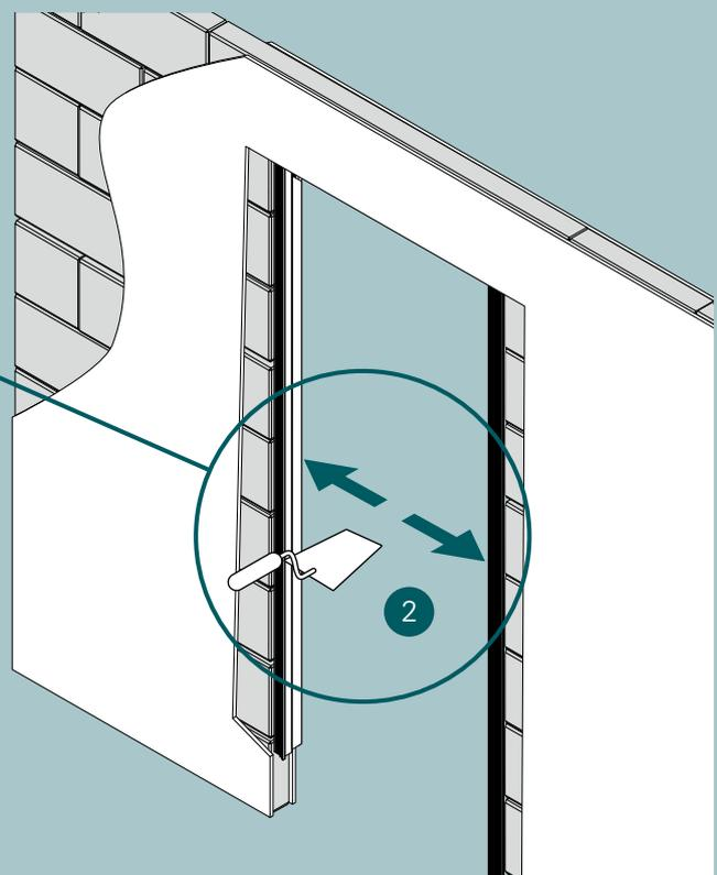
Damit die Putzschicht eine gleichbleibende Stärke hat, können einzelne Bereiche mit Streifen aus Putzträgerplatten aufgefüllt werden.
