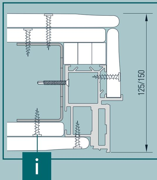
Schraubenlöcher in den UA- oder Zargenprofilen mit einem 2 mm Metallbohrer vorbohren!
