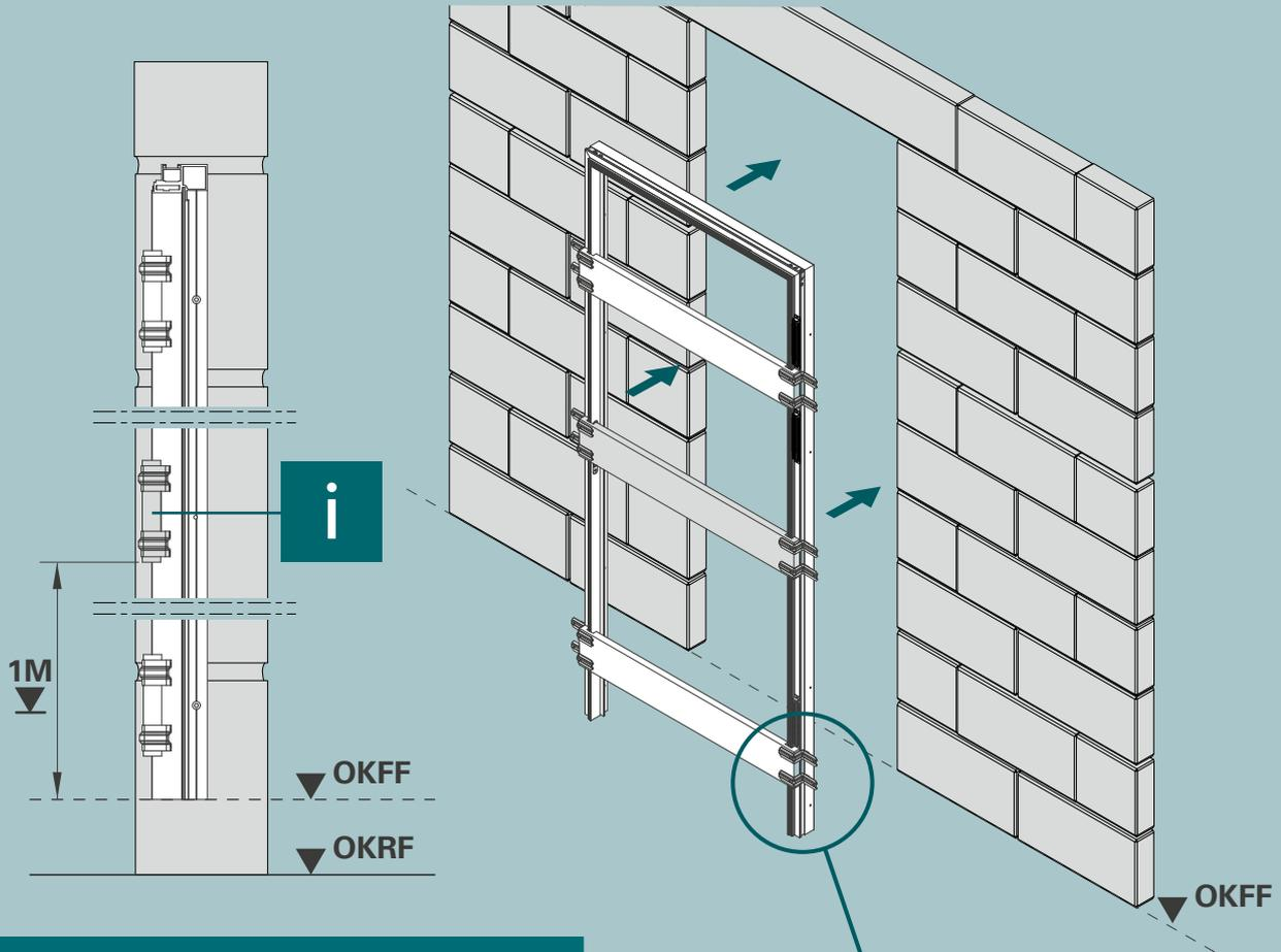
Die Unterkante des zweiten Distanzbrettes markiert den Meterriss. Anhand dieser Markierung kann die Einbauhöhe jederzeit bestimmt werden.
