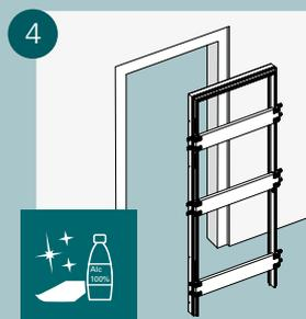
Bevor Sie die Zarge einsetzen: Prüfen Sie, ob die Zargenprofile und die Maueröffnung staub und fettfrei sind, damit der Montage-schaum später gut haften kann.
