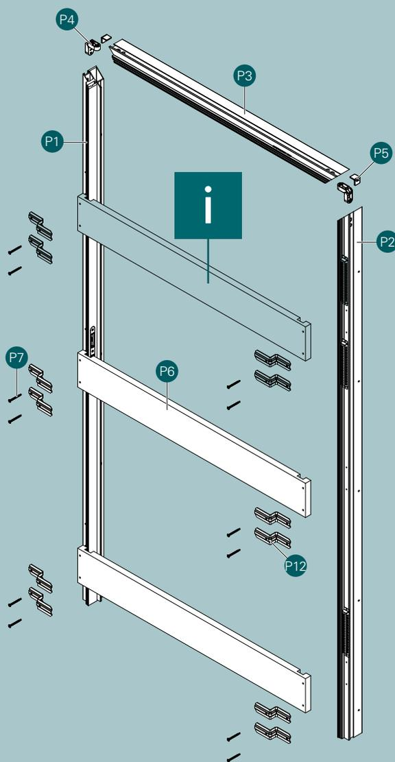
Vidar Spachtelzarge mit Komponenten für Mauerwerk
