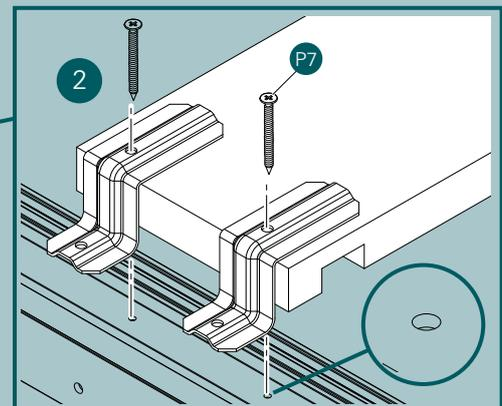
Stimmen Sie die Anschlagwinkel auf die Wandart (Mauerwerk: P12 oder Metallständerwerk: P10) ab.
