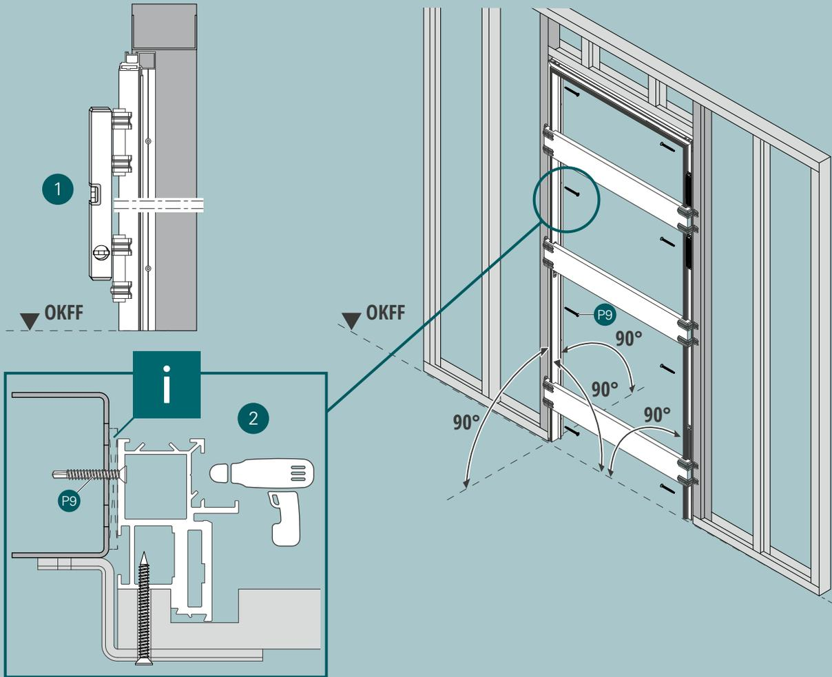
Eventuell auftretende Spalte zwischen UA-Profil und Zarge müssen an den Befestigungsstellen vor dem Anschrauben druckfest hinterfütert werden!
