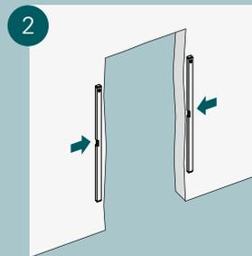
Entfernen Sie alten Bauschaum. Ist die Maueröffnung zu eng, stemmen Sie das Mauerwerk in diesem Fall an den entsprechenden Stellen vorsichtig nach.
