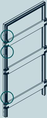
Die Bänder sind auf der Seite, auf der die Tür durch Ziehen geöffnet wird, links angeschlagen
