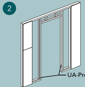
Entfernen Sie die alten Gipskartonplatten um der Wandöffnung herum. Prüfen sie, ob die beiden Metallständer an denen die Zarge befestigt wird, aus 2 mm starken UA-Profilen bestehen. Tauschen sie diese ggf. aus.
