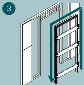
Optional: Um die Schallübertragung zu verringern, können Sie die Laibung des Ständerwerks mit bauseitigem Dichtungsband versehen. Achten Sie darauf, dass die Wandöffnung umlaufend entsprechend der Dicke des eingesetzten Dichtungsbandes vergrößert wird.
