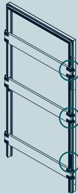
Die Bänder sind auf der Seite, auf der die Tür durch Ziehen geöffnet wird, rechts angeschlagen
