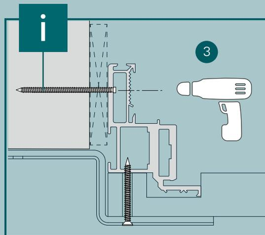
Vor dem Anschrauben die Befestigungsstellen druckfest hinterfüllen!
