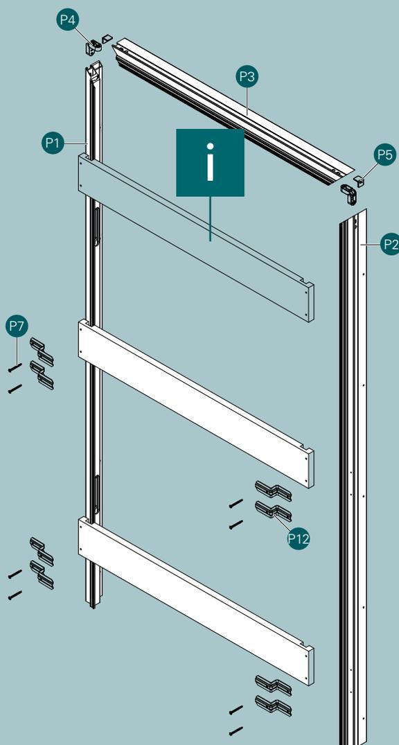
Vidar Spachtelzarge mit Komponenten für Mauerwerk
