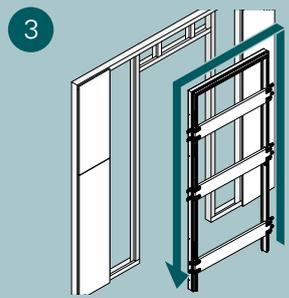
Optional: Um die Schallübertragung zu verringern, können Sie die Laibung des Ständerwerks mit bauseitigem Dichtungsband versehen. Achten Sie darauf, dass die Wandöffnung umlaufend entsprechend der Dicke des eingesetzten Dichtungsbandes vergrößert wird.
