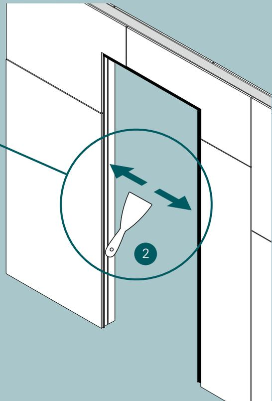
Die Verwendung von glasfaserverstärkter Spachtelmasse wird empfohlen!
