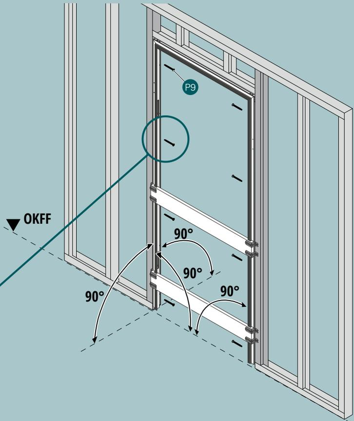
Eventuell auftretende Spalte zwischen UA-Profil und Zarge müssen an den Befestigungsstellen vor dem Anschrauben druckfest hinterfütert werden!
