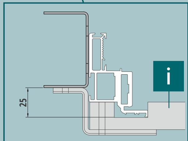
Die Anschlagwinkel sind für eine doppelte Beplankung (insgesamt 25 mm) ausgelegt.
