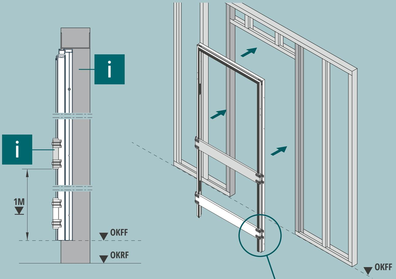
Um das Gewicht des Türblatts zu halten, muss die Türöffnung mit zwei senkrechten, 2 mm starken UA-Profilen erstellt werden.
