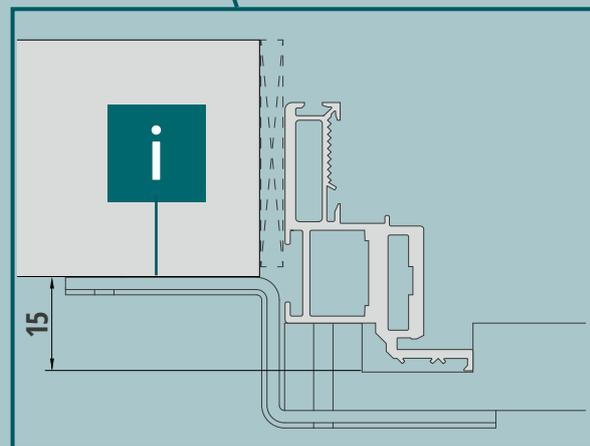
Bei Putzstärken, die größer als 15 mm sind, können die Anschlagwinkel hinterfütert werden.
