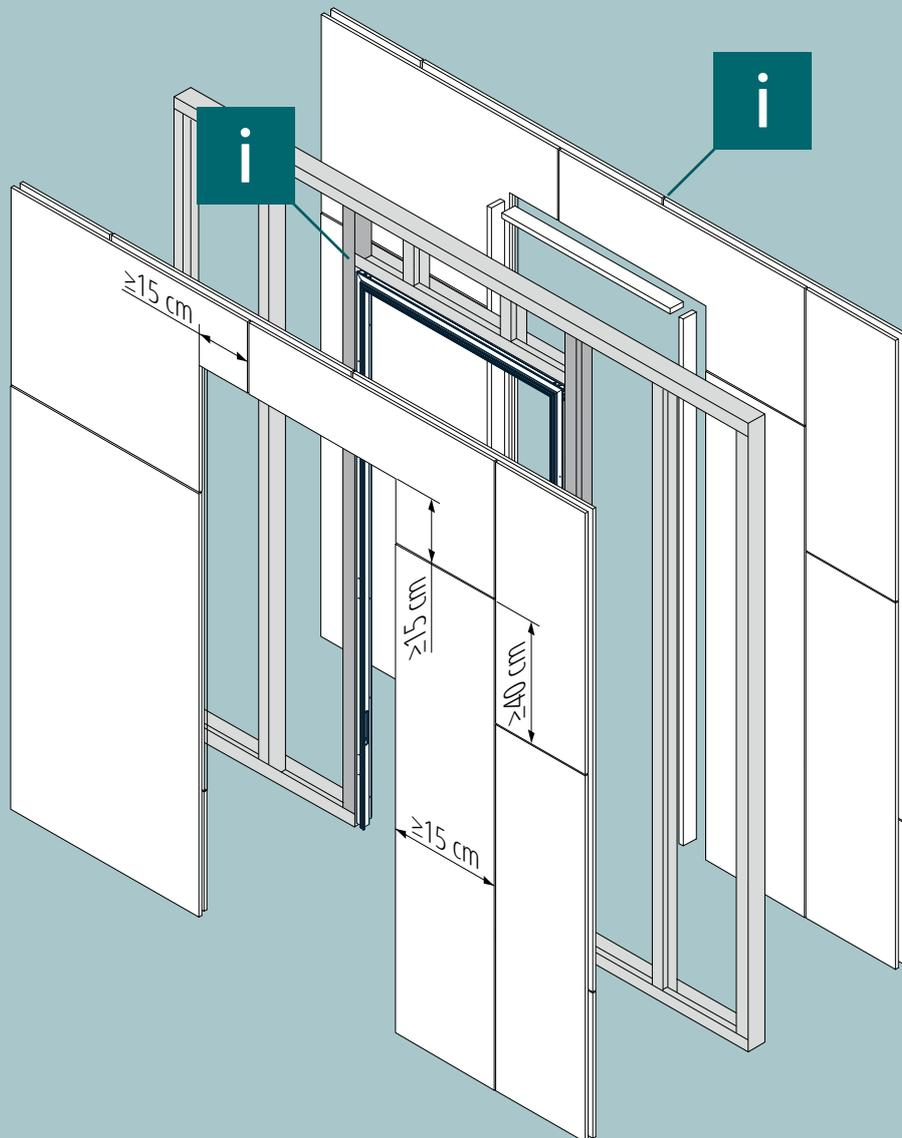
Plattenstöße der ersten und zweiten Lage im Sturzbereich nicht auf den UA-Profilen enden lassen. Sparen sie die Platten über Eck aus und halten Sie die angegebenen Abstände beim Versatz ein.
