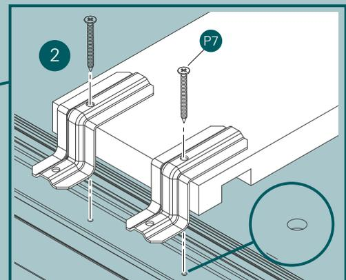
Stimmen Sie die Anschlagwinkel auf die Wandart (Mauerwerk: P12 oder Metallständewerk: P10) ab.
