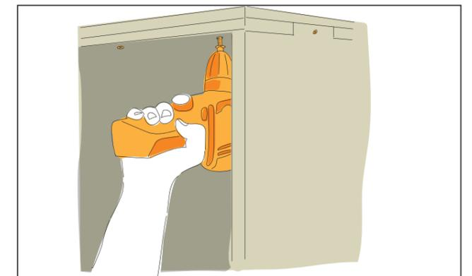
Die Arbeitsplatte von unten durch die vorgesehenen Bohrlöcher der Abdeckplatte mit 3x25 mm Schrauben verbinden.
