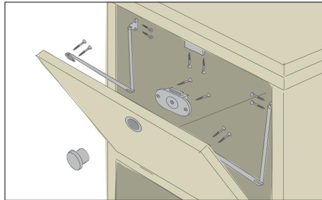
Das Möbelschloss mit Senkkopfschrauben 3x16 mm wie gezeigt an der jeweiligen Tür montieren. Seitlich erhalten die Türen jeweils zwei Klappenhalter. Diese werden mit den mitgelieferten Schrauben befestigt.
