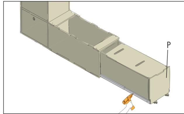
Die Schublade vor dem Befestigen an den beiden Schienen so ausrichten, dass die Frontblende (P) auf allen Seiten leicht Spiel hat. Dann die Schublade mit 4x16 mm Schrauben mit den Schubladenschienen verschrauben. Beim Ausrichten weiterhin darauf achten, dass die Schienen parallel zur Schublade verlaufen.
