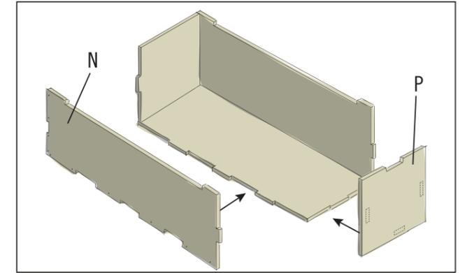
Das Wandelement (N) ebenfalls anfügen und verschrauben. Die Schubladenfront (P) wird von vorne aufgesteckt
