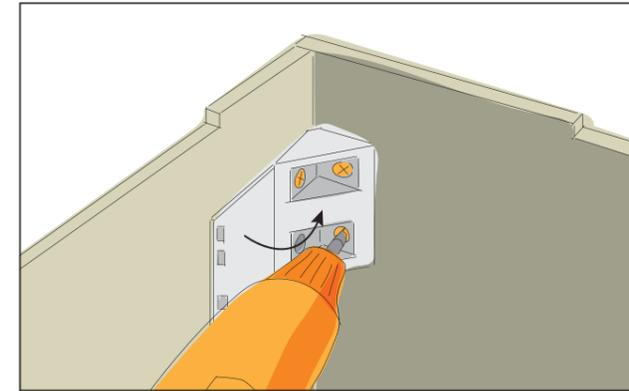
Die Schubladenfront an den beiden Wandelementen von innen mit jeweils zwei Eckverbindern und Schrauben 3x16 mm verschrauben.
