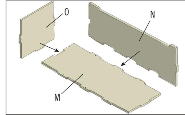
Die Bodenplatte (M) und die Wandelemente (N und O) an den vorgesehenen Aussparungen verbinden und verschrauben. Die Verschraubung erfolgt seitlich und von unten durch die Bodenplatte.
