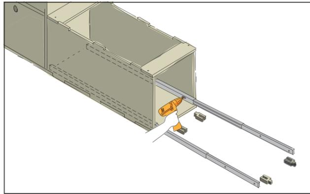
Die beiden Schubladenschienen für die Schublade werden unten im Korpus an den Wänden mit 4x16 mm Schrauben verschraubt. Die Montage der Schublade sollte auf einem ebenen und stabilen Untergrund erfolgen. Zum Ausrichten der Schublade kann man sehr gut Unterlegkeile verwenden. Sie sollte mit 17 mm unterbaut werden, damit sie beim Rein- und Rausschieben frei gleiten kann ohne zu schleifen.
