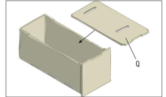
Die Abdeckung (Q) wird lose aufgelegt - also nicht verschraubt. Sie kann zum Beladen der Schublade an den Griffschlitzen leicht abgenommen werden. Jetzt müssen noch die Schubladenschienen montiert werden.
