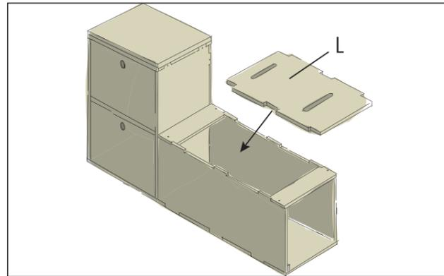
Die Abdeckung (L) kann probeweise aufgelegt werden. Sie bleibt auch später lose, damit sie zum Beladen der Schublade abgenommen werden kann.
