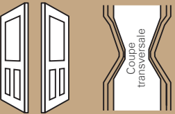
Variante 1 : Relief sur le côté feuillure et le côté de retournement (bilatéral)
