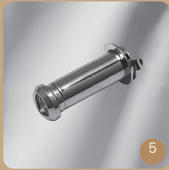
Microvisseur : peut être commandé pour un perçage de Ø 12 mm ; le trou du microvisseur est réalisé à l'usine. Le microvisseur est livré en vrac pour le montage. Alternative : Commande d'un trou de microvisseur et utilisation par le client d'un microvisseur disponible dans le commerce.
