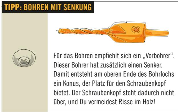
**TIPP: BOHREN MIT SENKUNG**
