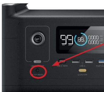
b.) Hierzu muss die IOT-Taste an der Powerstation gedrückt werden, bis das Wi-Fi Symbol des Gerätes zu blinken beginnt.
