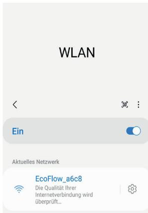
c.) Öffnen Sie nun in die Wi-Fi Einstellungen auf Ihrem Endgerät (Smartphone od. Tablet). Dort erscheint ein neues „Ecoflow Netzwerk“. Nun verbinden Sie Ihr Endgerät mit dem Ecoflow Netzwerk. Nachdem die Verbindung mit der Powerstation erfolgreich hergestellt wurde, kehren Sie zur EcoFlow-App zurück.
